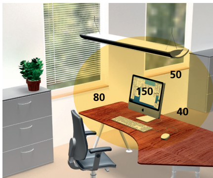
Zulässige Unterschiede der Flächenhelligkeiten bei richtiger Bildschirmaufstellung (die Zahlenwerte geben Leuchtdichten in \text{cd/m}^2 an)
