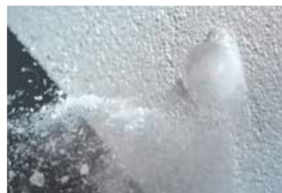
Aufnahme Hochgeschwindigkeitskamera – das WDV5 hält dem Hagelschauer stand.
